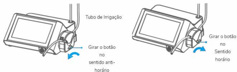
Figura 09- Instalando o tubo de irrigação na bomba da unidade de controle.
